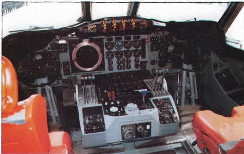
**To cockpit tou aeroplánu. Aριστερά η θέση του κυβερνήτη, δεξιά του συγκυβερνήτη και στη μέση λίγο πιο πίσω του ιπταμένου μηχανικού.** Η στρογγυλή οθόνη τροφοδοτείται με στοιχεία ναυτιλίας και τακτικής. Δίπλα της, τα όργανα ενδείξεων για τους τεσσερις κινητήρες. Οι κίτρινοι διακόπτες ακριβώς από πάνω χρησιμεύουν για τη διακοπή παροχής καυσίμου στους κινητήρες σε περίπτωση ανάγκης.
